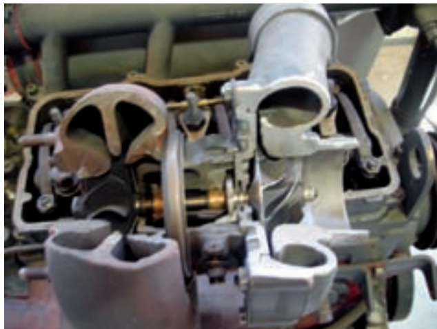
Figura 8. Sección de un turbo compresor frontal
