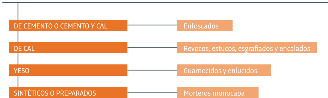
Figura 5. Clasificación de los revestimientos continuos según el conglomerante. Fuente: Carlos-E. Agell Magriñá. Ejecución de enfoscados y guarnecidos "a buena vista". Tornapunta Ediciones
