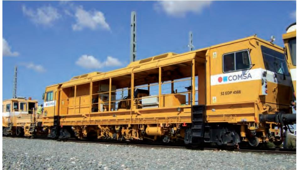
Figura 7. Estabilizador dinámico. Fuente: COMSA
