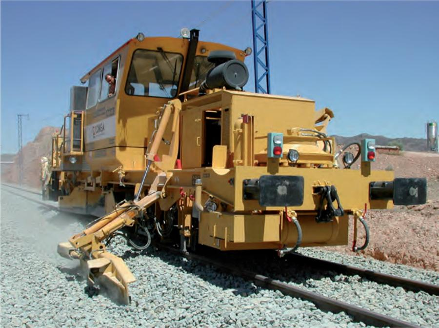
Figura 6. Perfilado de la vía. Fuente: COMSA
