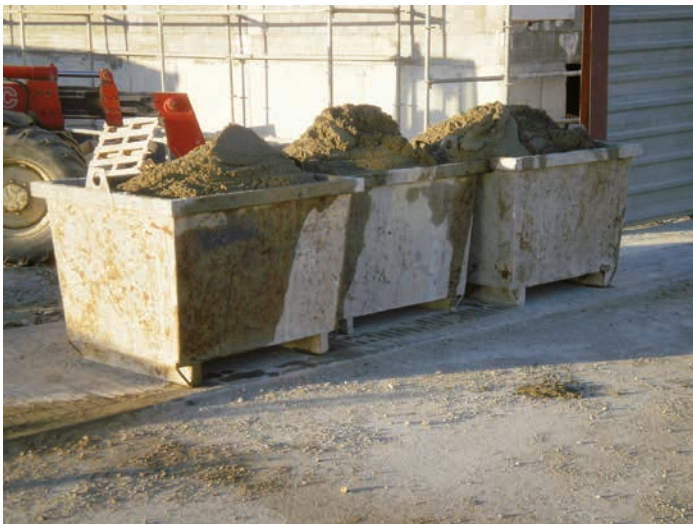
Figura 2. Mortero húmedo o fresco preparado en fábrica
