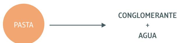
En cambio, un **mortero** es un producto que se obtiene si se mezcla un conglomerante con agua y arena. Por ejemplo, el mortero de cal, que se elabora con cal, agua y arena.
