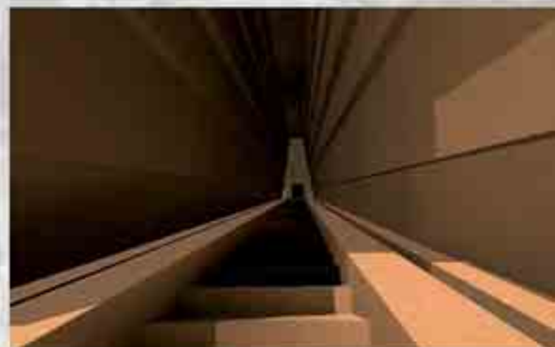
Gran Pirámide. Gran Galería construida con piezas en voladizo. Esquema conceptual
