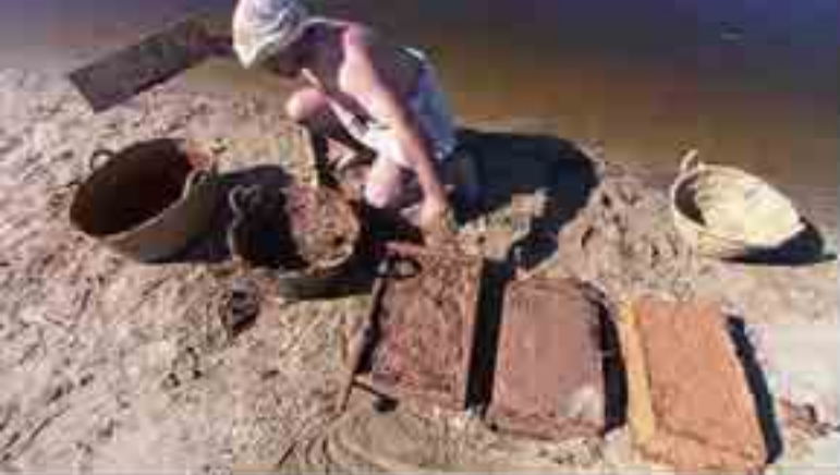
Ejecución de adobe
