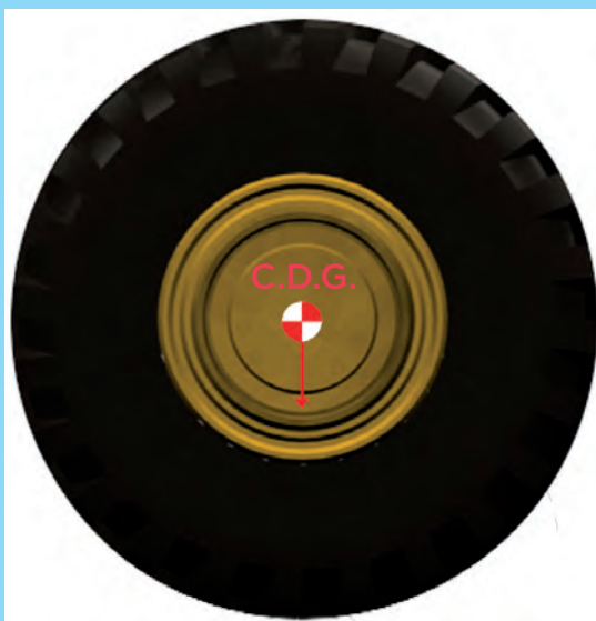
Figura 4. Centro de gravedad de una rueda
