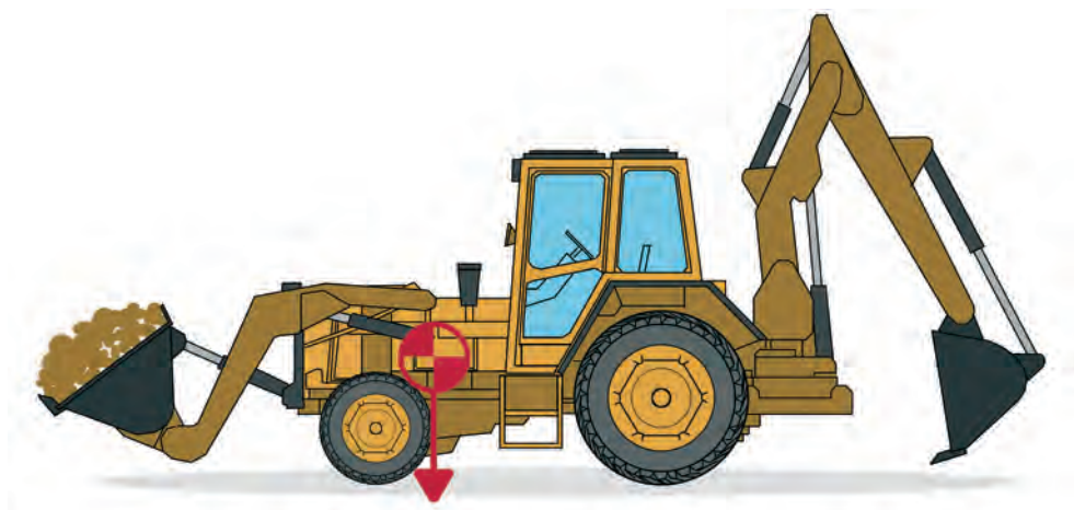
Figura 9. Centro de gravedad desplazado por la carga
