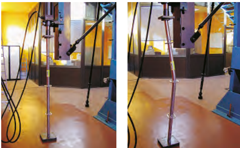
Figura 1. Ensayo de rotura o agotamiento de una pieza
