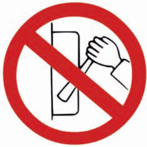
Figura 2. Señal de prohibido conectar
