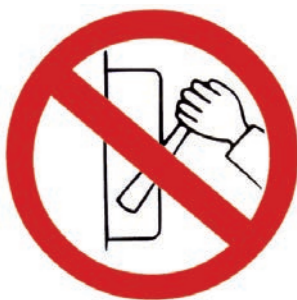
Figura 2. Señal de prohibido conectar
