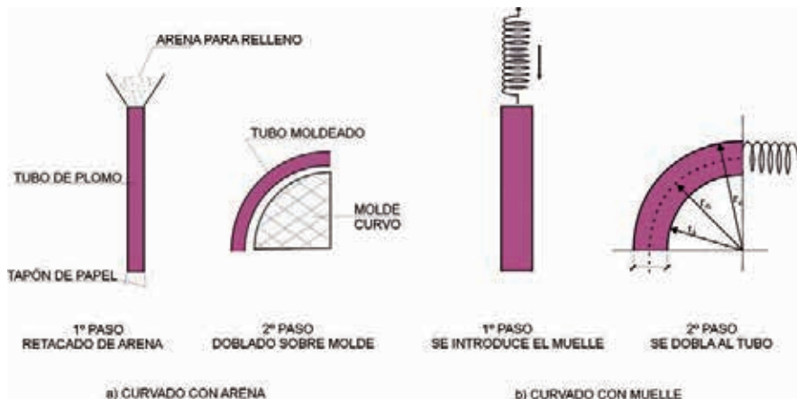
Figura 3. Curvado de tubos de plomo
