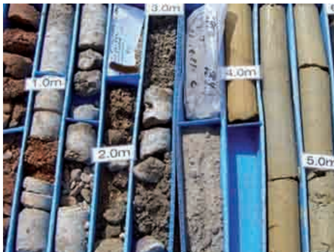
Figura 3. Testigos del terreno obtenidos de la perforación geotécnica
