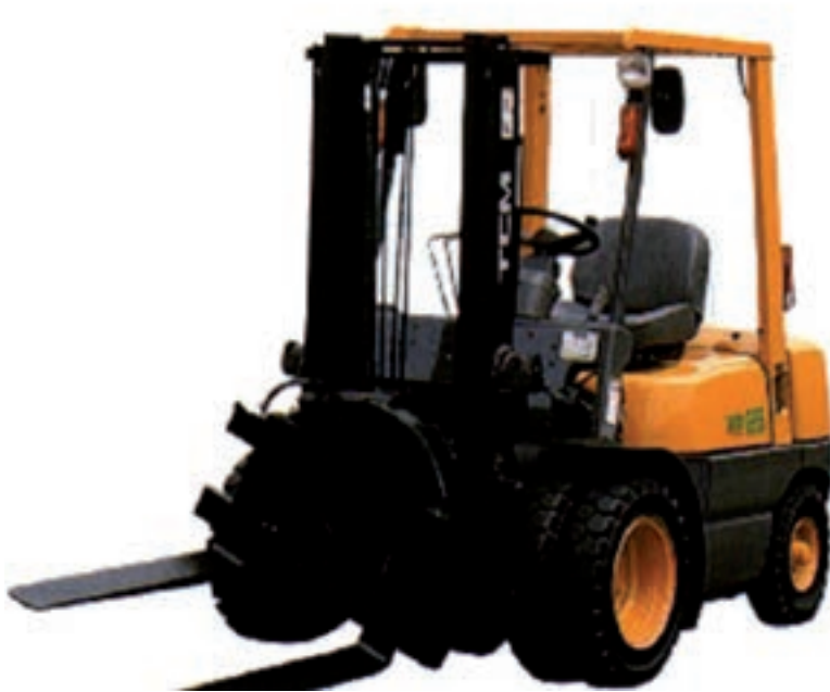
Figura 1. Carretilla con dos ruedas directrices. Fuente: Spanich.alibaba.com
