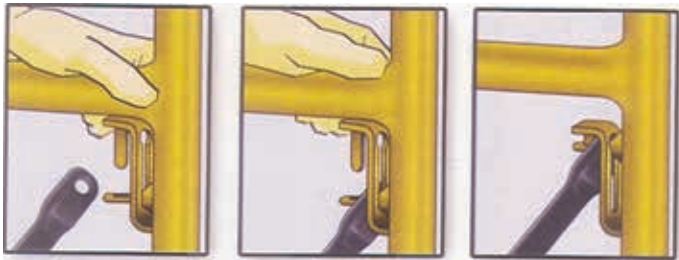
Figura 6. Detalle de un andamio de marco fabricado sin cumplir la normativa vigente
